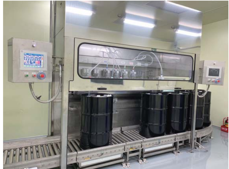
無塵室Class 100等級 各式充填站可充填各式包裝容器 Tote/200L/20L/10L/1Ga1/1L
