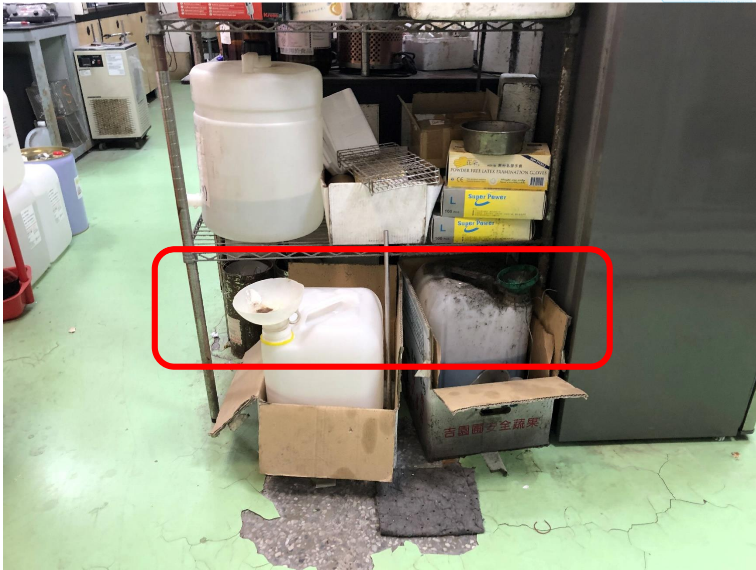
實驗室中之廢液收集桶，容器開口易導致物質逸散
