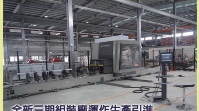
全新三期組裝廠運作生產引進 義大利 Emmegi 5軸CNC中心加工機
